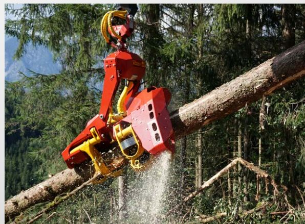
Le WOODY a une grande longueur totale, ce qui permet l'abattage contrôlé des arbres forts.
