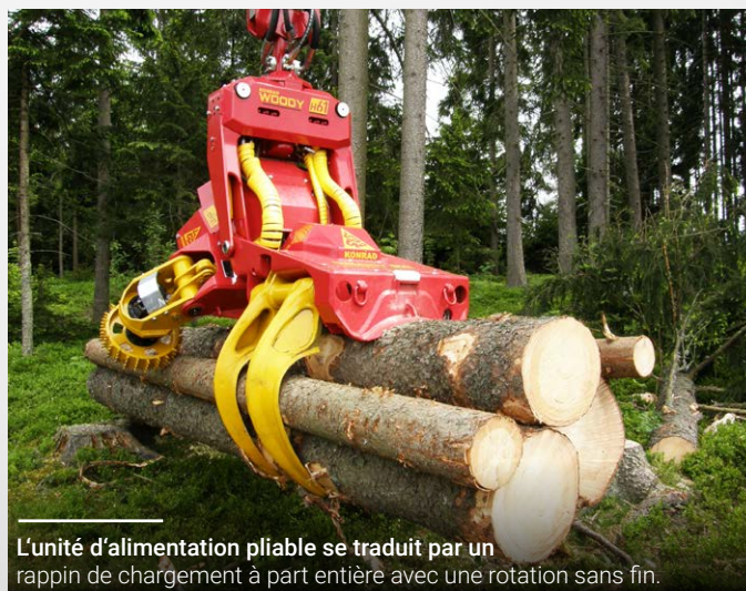
Le WOODY a une grande longueur totale, ce qui permet l'abattage contrôlé des arbres forts.
